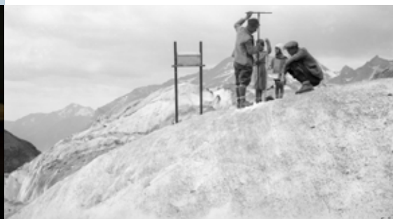
Umberto Monterin - Gressoney-La-Trinité, Ghiacciaio del Lys. Operazioni all'ablatografo e al carotatore, 1933
